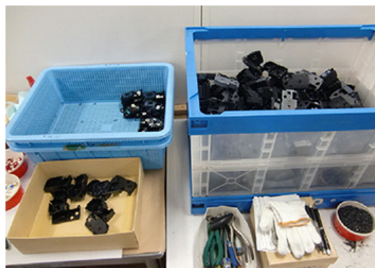
テーブカートリッジとインクリボンカセットの分解・分別
