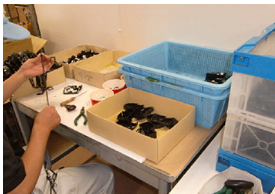
テーブカートリッジとインクリボンカセットの分解・分別
